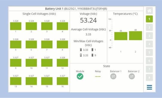
Ein Batteriemodul enthält zwei Batterieblöcke mit jeweils acht Zellen. Die detaillierte Ansicht der einzelnen Batteriemodule ermöglicht eine genauere Betrachtung jeder Zelle, ihrer Spannung sowie der Temperatur jedes Batterieblocks.
