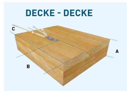
**A** Mindestdicke 100/120/140 mm und Maximaldicke 120/140/160 mm jeweils ab Verbinderoberkante für Schraubenlängen 100/120/140 mm; ggf. Verbinder tiefer einfräsen
