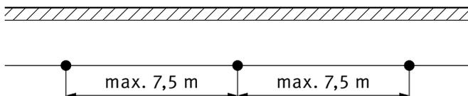
Dieser Einzelanschlagpunkt kann auch als Anfangs-, End- oder Eckstütze, bzw. Zwischenhalter von Seilsystemen BR 1, BR 6 und BR 8, verwendet werden.
