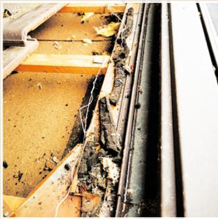
Überreste des alten Moosgummistreifens entfernen, Klebefläche mit geeignetem Werkzeug vorbereiten (Spachtel, Schleifpapier, Scotchbrite, usw.)
