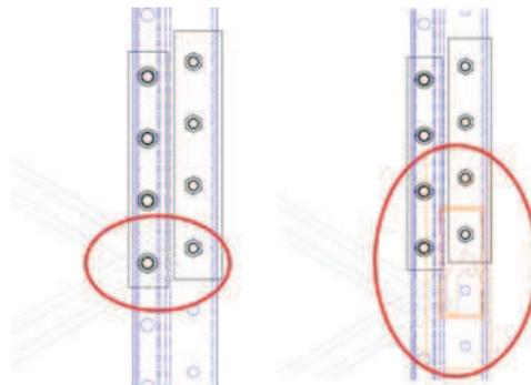
Falls Aufstockelemente und Kreuzpunkte von Horizontalen und Diagonalen der Rahmenverstrebung zusammentreffen, müssen von Fall zu Fall Sonderlösungen gefunden werden, die von der Tiefe und Höhe des Originalrahmens abhängen.
