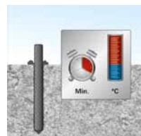
Beim Setzen muss Überschussmörtel entweichen, dann Aushärtezeit beachten.
