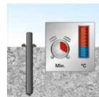
Mörtelfüllmenge kontrollieren. Aushärtezeit beachten.
