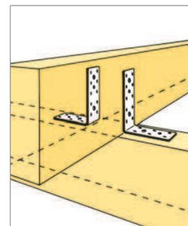
Balken / Pfetten und Balken / Stützen Anschlüsse
