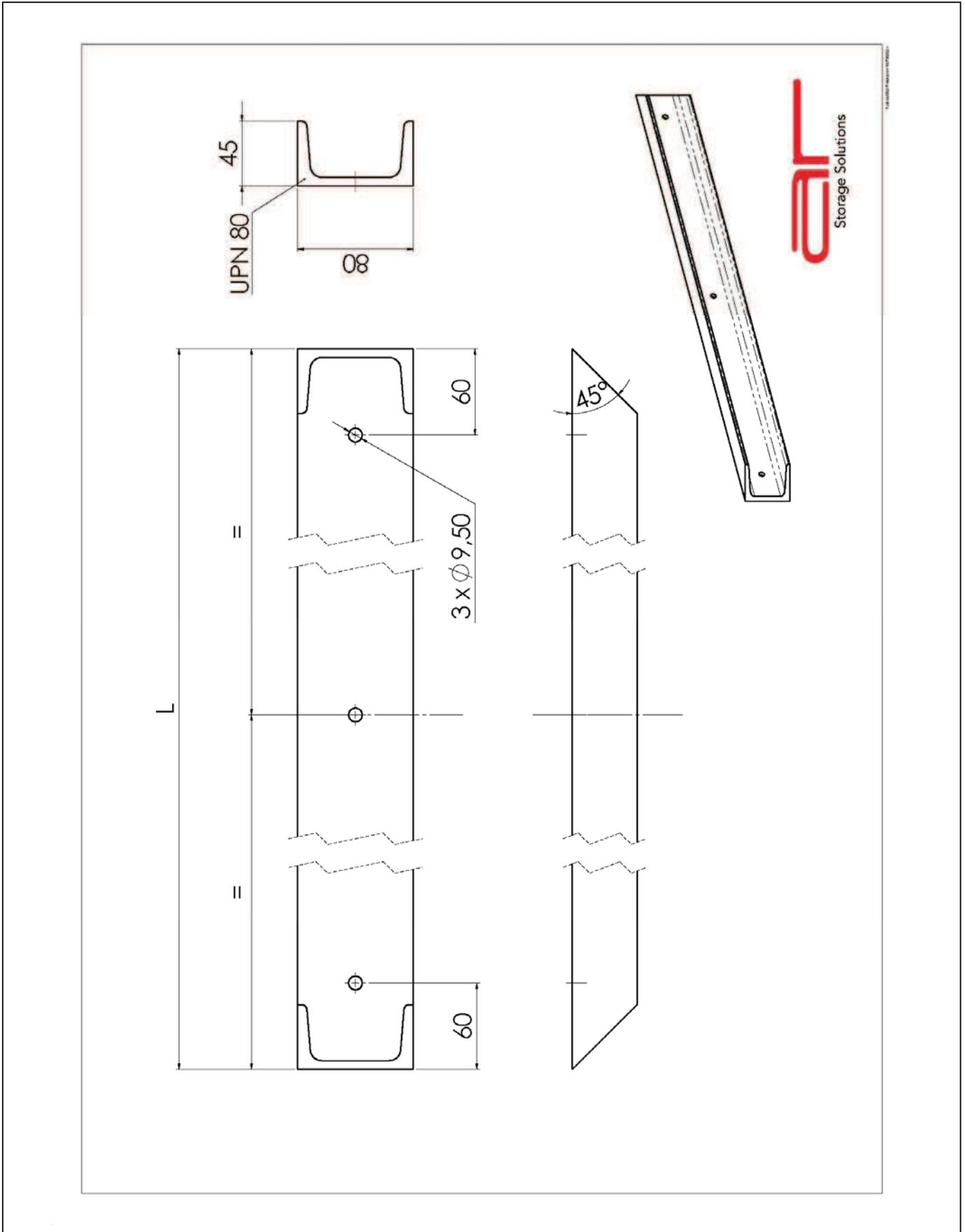
Der SATZ SEITL. RAHMENSCHUTZL beinhaltet die Verschraubung mit dem Stützen bzw. Rahmenschutzteilen:
