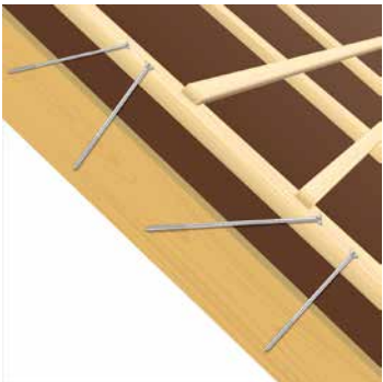
Konterlattenbefestigung mit den DA-Holzbauschrauben bei druckfesten Aufdach-Dämmsystemen.
