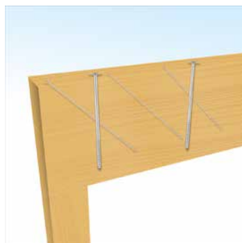
Die DA-Holzbauschrauben sind auch bei Sanierungen sehr vielseitig einsetzbar, z. B. bei seitlichen Verstärkungen von Balkenlagen oder deren Aufdoppelungen gegen das Durchbiegen.
