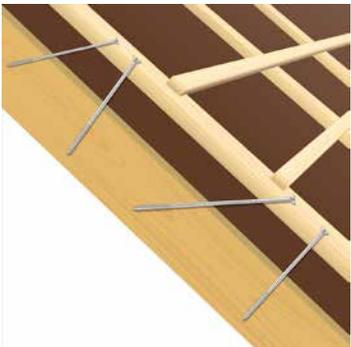
Fixation de contre-lattes sur chevrons à travers une isolation résistante à la pression.
