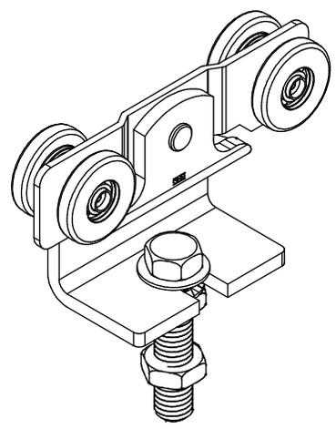
Monture à galets acier sur roulements à billes
