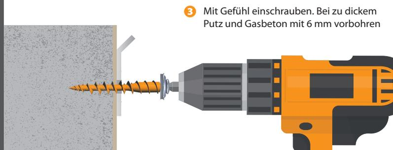
**3** Mit Gefühl einschrauben. Bei zu dickem Putz und Gasbeton mit 6 mm vorbohren
