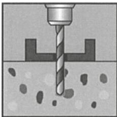
Bohrloch dreh-schlagend bis zur erforderlichen
