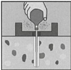
Bohrmehl entfernen, z.B. durch Ausblasen
