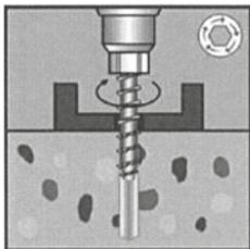
Setzen des Schraubankers mit Tangential-
