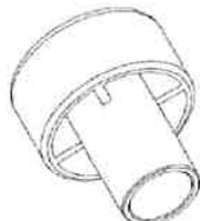
**Verfüllstutzen für Überkopf- oder Horizontalmontage**
