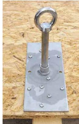
Élément de fixation: 12 x vis à bois tête ronde A2 6,0 X 100 TX25
