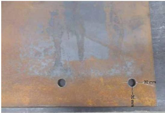
Distance de bordure minimale pour le perçage 30 mm
