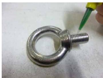
5) 7) Sécuriser l'anneau et la rondelle avec du frein-filet forte résistance (par ex. Loctite)
