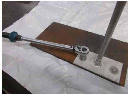
4.) Serrage des vis à 50 Nm
