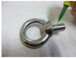
Sécuriser l'anneau et la rondelle avec le frein-filet forte résistance (par ex. Loctite)
