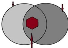
Bei Überschneidung der Bohrlöcher müssen min. 10 mm Luft bleiben für die M 8 x 70.
