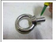
7) Zur Sicherung der Ringöse . Zahnscheibe und Ringschraube mit Schraubensicherung hochfest (z.B. Loctite) einkleben
