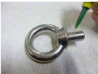
11) Zur Sicherung der Ringöse Zahnscheibe und Ringschraube mit Schraubensicherung hochfest (z.B. Loctite) einkleben.
