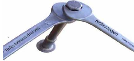
10) Zum Lösen der Setzhilfe halten Sie den obersten Maulschlüssel fest und den untersten Maulschlüssel drehen Sie kurz nach links. Nun können Sie die Setzhilfe herausdrehen
