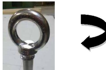
12) Ringöse aufsetzen und rechts herum eindrehen. So festziehen, dass die Ringschraube mit der Hand nicht mehr zu lösen ist.
