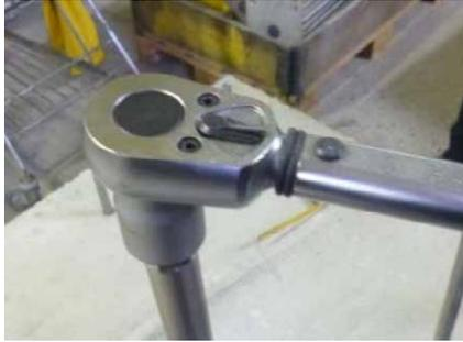
9) Anschließend mit 110 Nm festziehen
