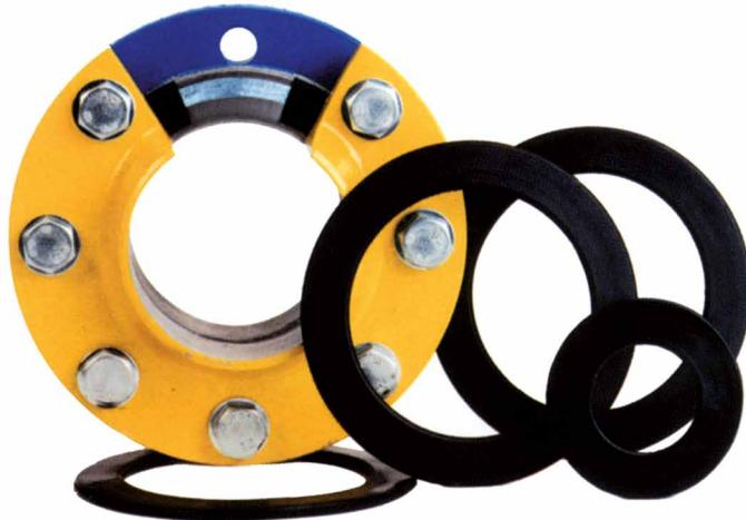
Keilflanschdichtung Typ G-S-S mit einvulkanisiertem Stahlring nach DIN EN 1514-1: Form IBC für Druckstufen von PN 6 bis PN 40
