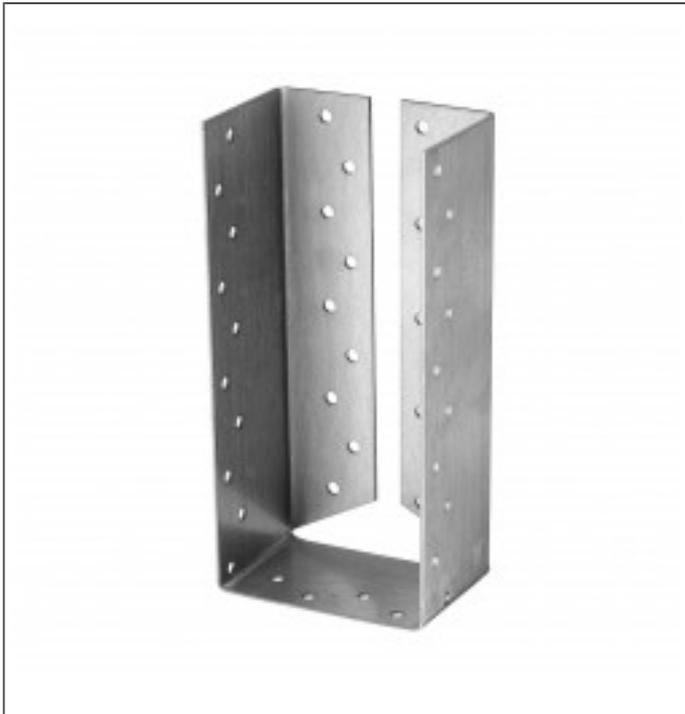
Die BSIL Balkenschuhe sind insbesondere zum Anschluss von Balken an Stützen konzipiert. Somit lassen sich bei 1-achsiger Belastung Balken an gleichbreite Stützen anschließen. Bei einer 2-achsigen Belastung sind die Randabstände (gemäß EC5 bzw. DIN 1052) der Nägel in der Stütze zu beachten.
