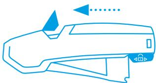
Ziehen Sie den **Klingenwechselknopf** nach oben heraus und betätigen Sie den Hebel. Klinge und Klingenhalterung treten aus dem Griff heraus.
