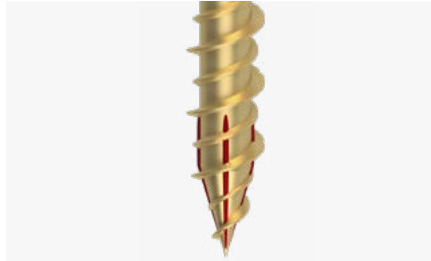
Spitze mit Kernrippen & HiLo-Gewinde (Verdichter Option 2)
