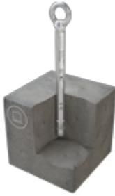
Mit dem ABS-Lock III-BE Pro-24 wird die Montage und jährliche Überprüfung einer individuellen Absturz-sicherungslösung zum Kinderspiel: Für die dauerhafte Befestigung genügt eine einzelne Bohrung in den Betonuntergrund des Flachdaches. Der Spezialdübel am unteren Ende der Stütze wird aufgespreizt, indem Sie mit einem handelsüblichen Drehmomentschlüssel die Mutter am oberen Ende anziehen (170 Nm).
